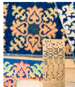
Der Jacquard-Webstuhl wurde Ende des 18. Jahrhunderts vom Franzosen Joseph-Marie Jacquard erfunden. Er revolutionierte damals mit dem Einsatz einer Lochkarte das Weben schwerer Stoffe mit aufwendigen Mustern.
