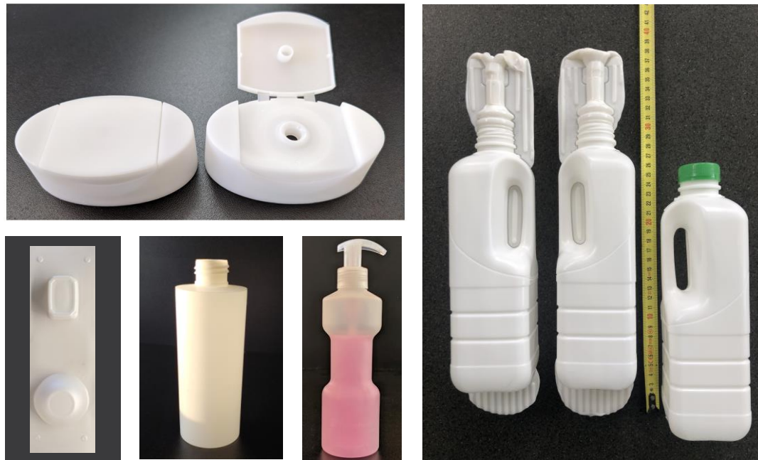
Demonstratorbauteile aus PBS: Lebensmittel- und Kosmetikverpackungen
