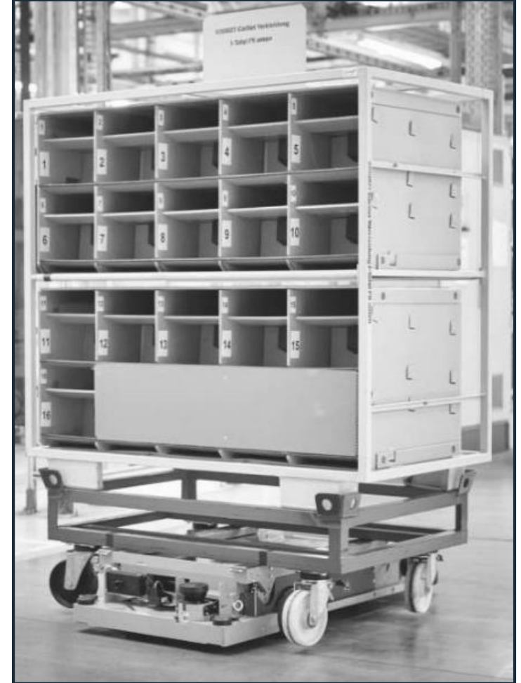
Beispiel: Fahrerloses Transportfahrzeug (FTF) inkl. Ladungsträger und Transportgut
