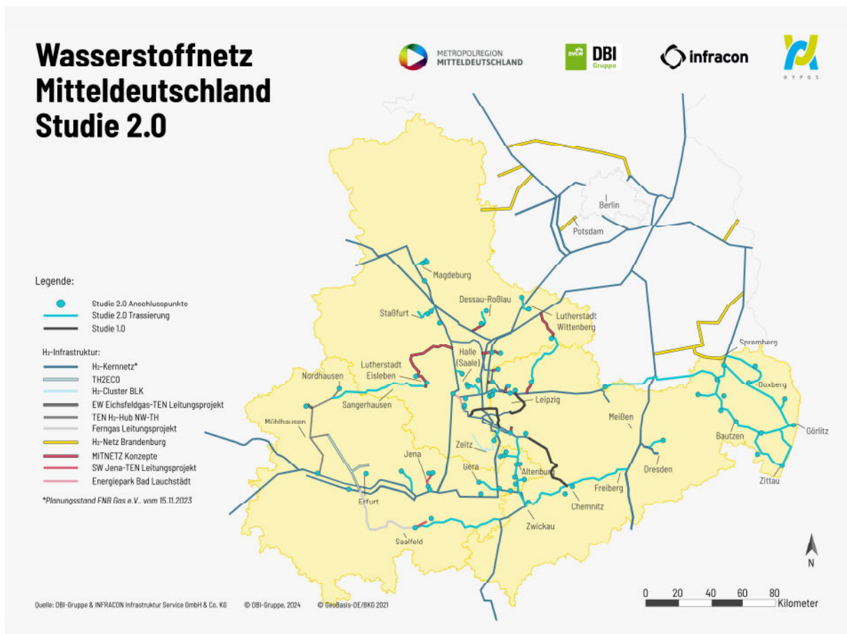
Abbildung 1: Trassierung des mitteldeutschen Wasserstoffnetzes der Studie 2.0
