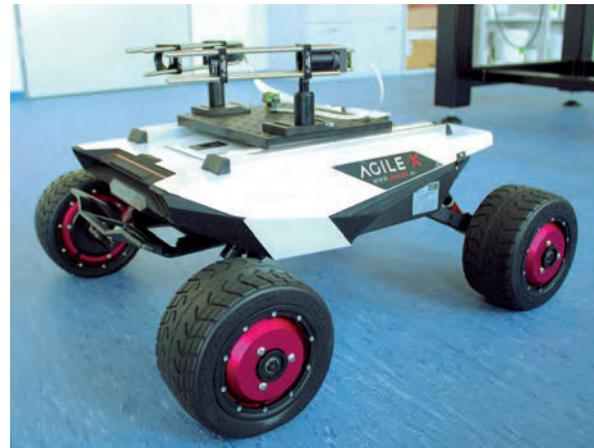
Agrar-Robotermodul mit montiertem optischem Versuchs-Sensor
