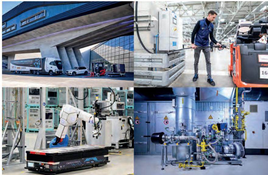
Wasserstoffbetriebene Fahrzeuge vor dem Zentralgebäude, manueller Tankvorgang eines Routenzuges mit Wasserstoff, vollautomatische Betankung eines fahrerlosen Transportfahrzeugs, bivalenter Wasserstoffbrenner in der Lackiererei
